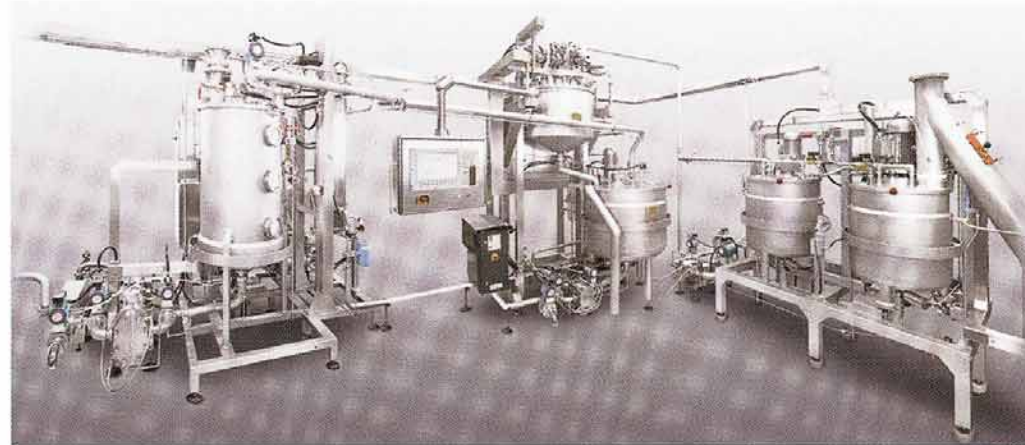
Der CrossFlow-Kocher (Foto rechts) wurde komplett neuentwickelt. Das Foto oben zeigt eine gesamte Gelee-Küche.
