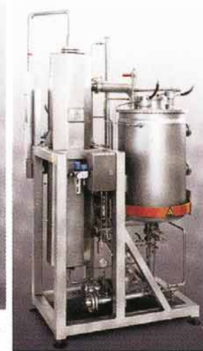
Der CrossFlow-Kocher (Foto rechts) wurde komplett neuentwickelt. Das Foto oben zeigt eine gesamte Gelee-Küche.
